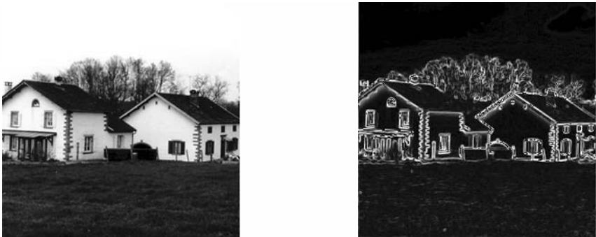
Figure 10.12 Détection des contours d’une image par convolution de type Sobel.
